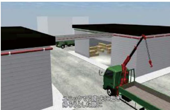
(a) クレーン搭載型トラックのブームの接触事故
