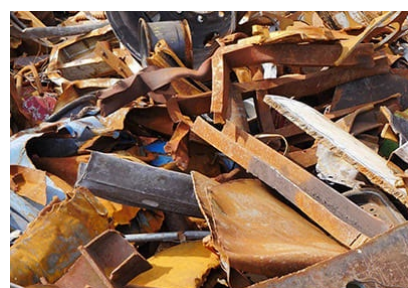
H1 H型鋼、鉄筋などの肉厚が6ミリ以上 ある鉄スクラップ
