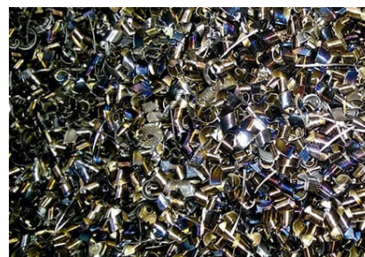
鋼ダライ 金属加工の工場から発生する 切削くず（切り粉、ダライ粉）
