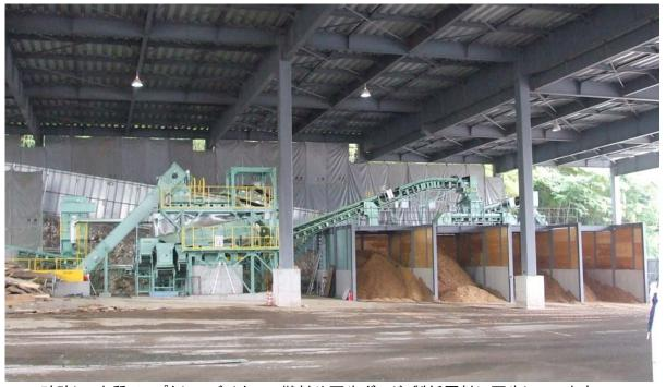
破砕し、木質チップとしてバイオマス燃料や再生ボード・製紙原料に再生しています。
