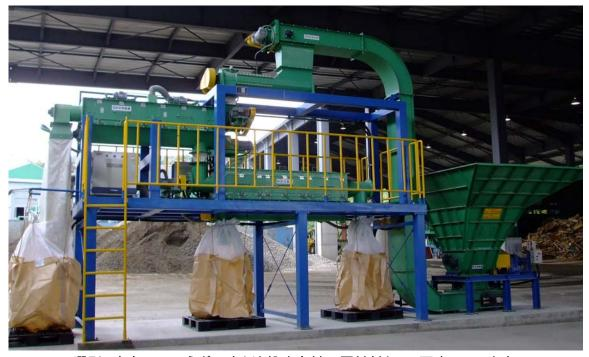
選別・破砕し、石こうボードや地盤改良材の原材料として再生しています。
