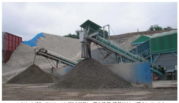
コンクリートガラ、アスファルトガラを破砕し、再生砕石・路盤材として再生しています。
